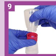
Dévissez le récipient supérieur vide pour récupérer l'échantillon. **IMPORTANT** : lors du dévissage, tenez le dispositif par le bouchon magenta et jamais par le réservoir inférieur.
