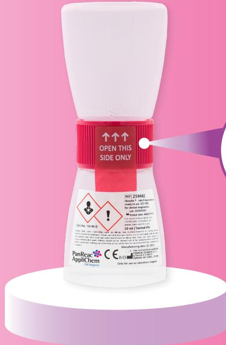
Histofix®-Safe es un dispositivo de seguridad de circulación cerrada, especialmente diseñado y patentado por ITW Reagents para la fijación y transferencia de pequeñas muestras histológicas, que evita la exposición del usuario a la solución de formaldehído.
